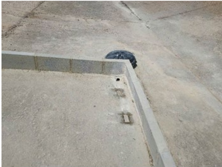
Cuneta fotocatalítica con incorporación de muestras-testigo en el hormigón
