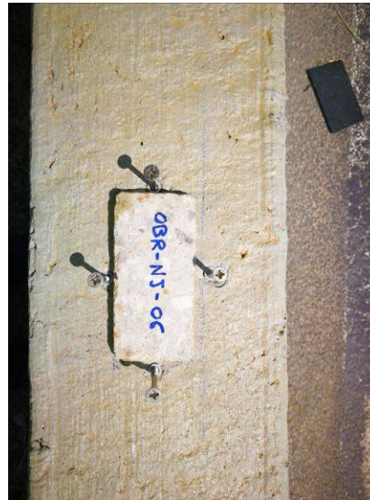
Detalle de muestras-testigo localizadas en obra, para ensayos de seguimiento
