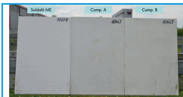
Figura 114: Comparativa de autolimpieza de pintura fotocatalítica con convencionales tras 5 años de exposición a intemperie. Fuente: KEIM.
