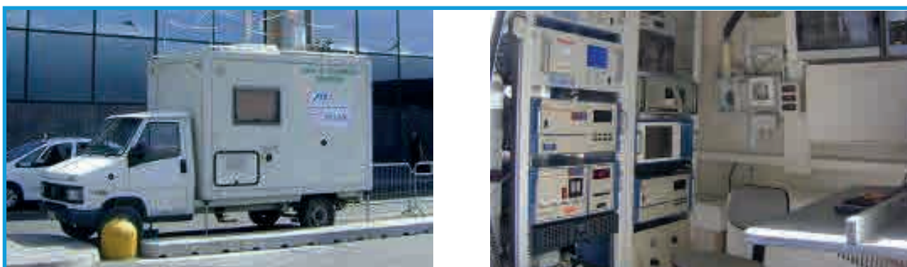
Figura 80: Estación móvil para la medida instalada en el Aeropuerto de Malpensa (Milán).
