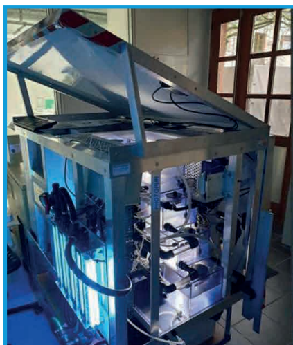
Figura 42: Fotorreactor desarrollado por el consorcio PHOTOPUR.
