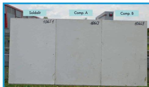
Figura 113: Comparativa de autolimpieza de pintura fotocatalítica con convencionales tras 5 años de exposición a intemperie. Fuente: KEIM.
