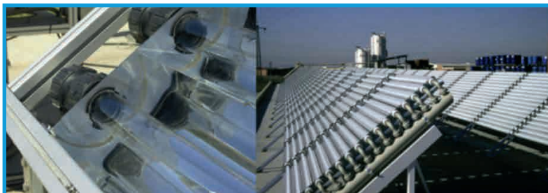
Figura 40: Vistas parciales de un CPC empleado para la fotocatálisis solar en la eliminación de contaminantes en agua (Spasiano et al. 2010).
