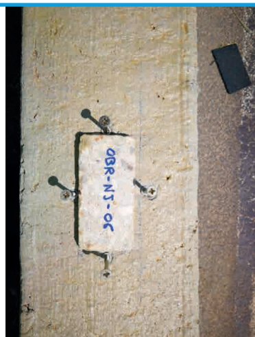
Figura 52: Ejemplo de muestra colocada en la superficie de tratamiento fotocatalítico (en este caso un elemento de contención de una carretera), para posterior seguimiento en laboratorio, por métodos normalizados. Fuente: AIF.
